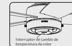
El LED tiene cinco configuraciones de color que van desde 2 700K (blanco cálido) a 6 500K (blanco frío). La configuración de fábrica del LED es 2700K. Si lo desea, ajuste el interruptor de cambio de temperatura de color del LED y cambie la temperatura del color.
